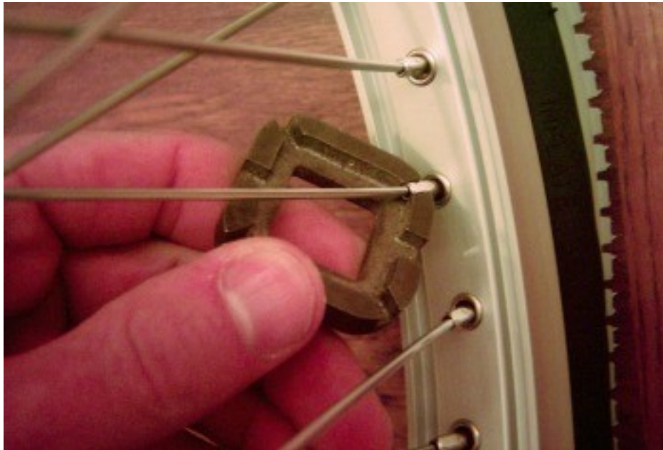
Figure 4: Le serrage des rayons, avec une clef spéciale.
