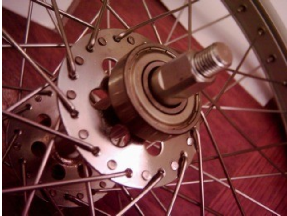
Figure 5: Sur cette photo, on voit nettement l'emmanchement carré destiné à recevoir la manivelle. On voit aussi le disque sur lequel viennent se monter les têtes des rayons. Ici, il s'agit d'une jante à 48 rayons.
