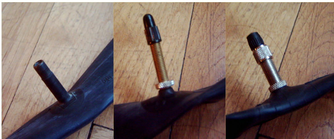
Figure 6: Les trois différents types de valves: de gauche à droite: la valve voiture(Schrader), la valve "vélo classique" (Presta) et la valve allemande (Dunlop).
