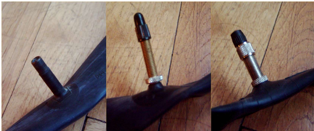
Figure 5: Les trois différents types de vannes: de gauche à droite: la vanne voiture, la vanne "vélo classique" et la vanne allemande.
