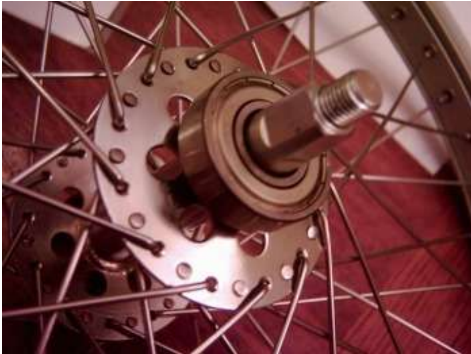
Figure 4: Sur cette photo, on voit nettement l'emmanchement carré destiné à recevoir la manivelle. On voit aussi le disque sur lequel viennent se monter les têtes des rayons. Ici, il s'agit d'une jante à 48 rayons.
